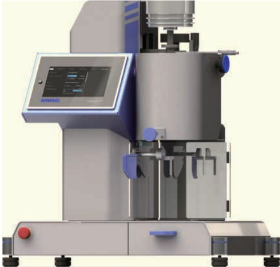
MeltFlow-Smart 基础版，手动砝码提升
