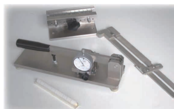
耐环境应力开裂测试仪
